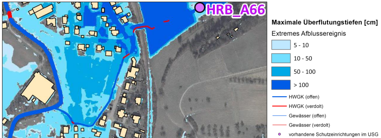
Abb.15: Überflutungstiefen bei einem extremen Abflussereignis (Quelle: WALD+CORBE, Sept. 2021)
